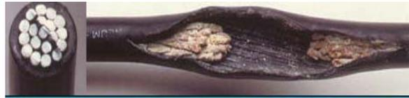
**Fig. 1.9.** Câble d'aluminium endommagé suite à la corrosion par l'eau
